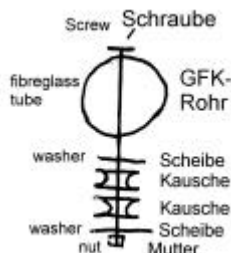
Vorbereitung der GFK-Enden
