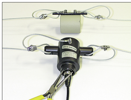
Bild 2: Ein Sperrkreis und der Balun des Dipols W-312; beim Anschließen des PL259-Steckers leistet eine spitze Zange gute Dienste.
