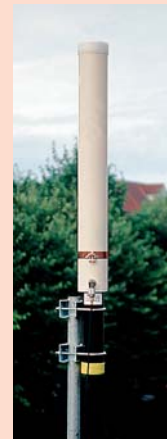
Die EH II als Balkonantenne.
