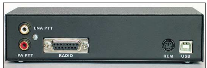
Der Digi Keyer von MicroHam vereint ein USB-Interface und eine hochwertige Soundkarte für Funkbetrieb in digitalen Betriebsarten.
