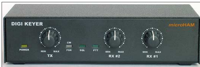
Der Digi Keyer von MicroHam vereint ein USB-Interface und eine hochwertige Soundkarte für Funkbetrieb in digitalen Betriebsarten.
