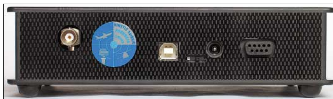
Bild 3: Auf der Rückseite der Basisstation liegen Buchsen für Antenne, USB-Schnittstellenkabel und externe Stromversorgung.
